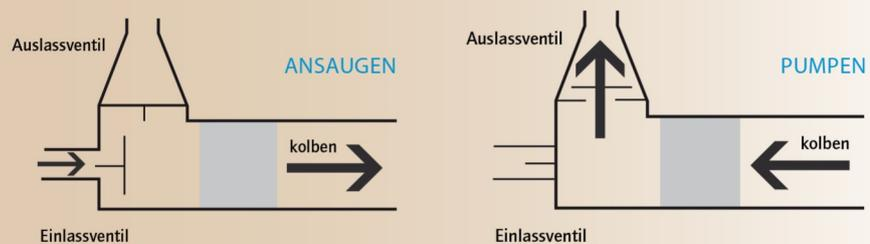
**Die Membranpumpe** funktioniert ähnlich wie eine Kolbenpumpe. Hier ist das Wasser durch eine Membran vom eigentlichem Fördermechanismus getrennt.
